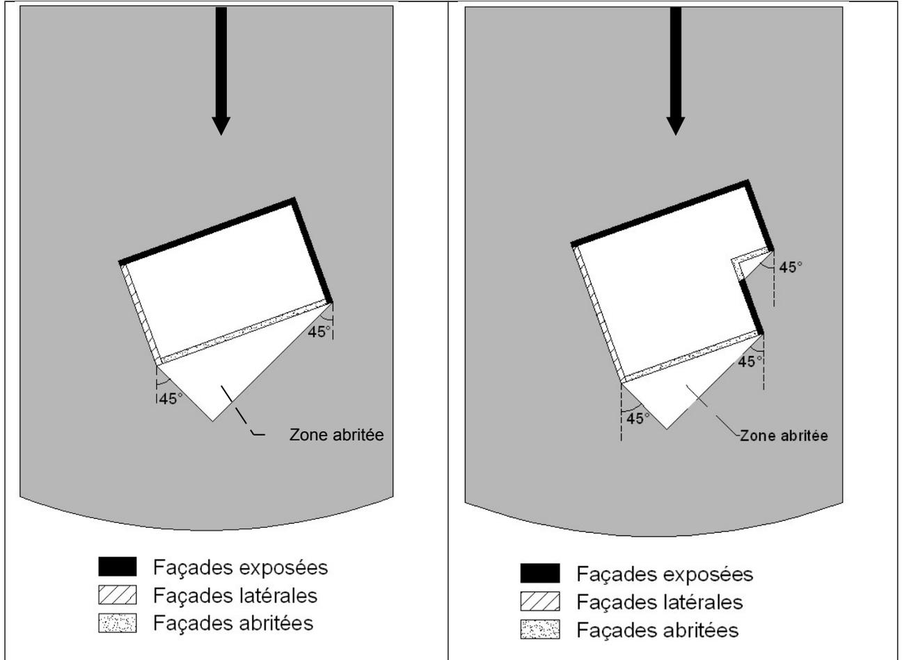
Cette zone abritée n'existe que si les façades exposées et latérales respectent les mesures de renforcement définies par le règlement du PPR :
