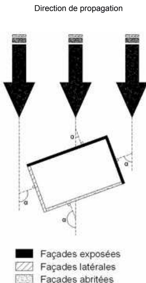
Toute disposition architecturale particulière ne s'inscrivant pas dans ces schémas de principe, devra être traitée dans le sens de la plus grande sécurité.
