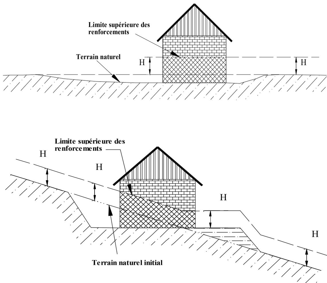
Figure 3: Définition des hauteurs de renforcements.
