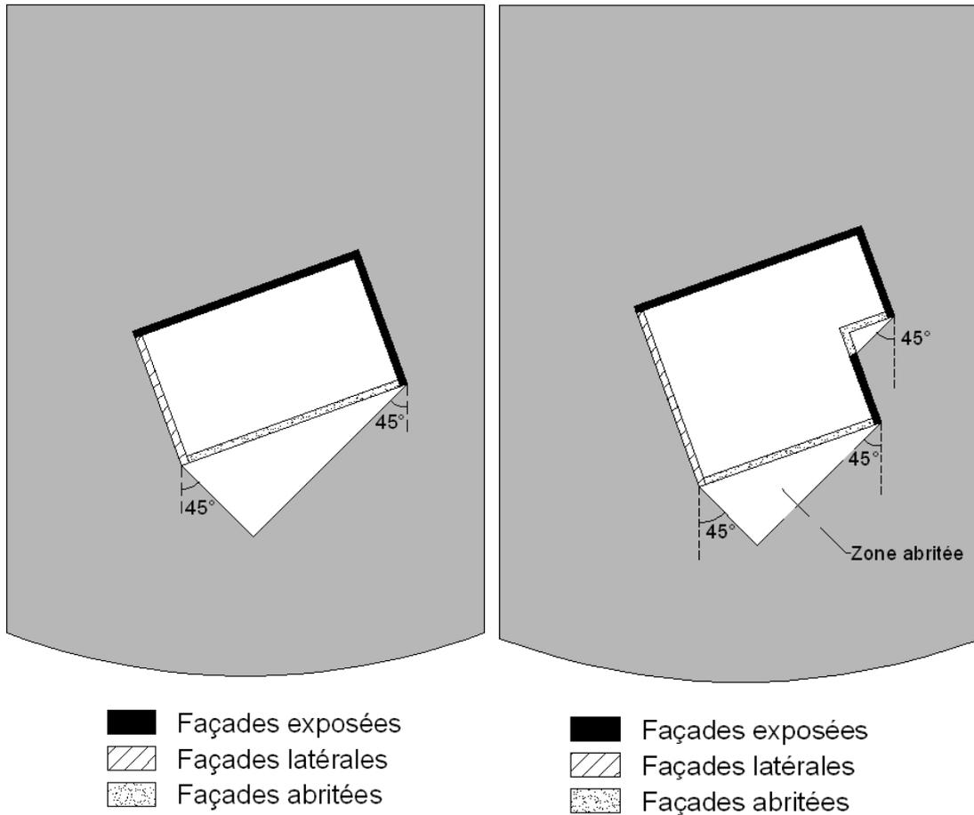
Cette zone abritée n'existe que si les façades exposées et latérales respectent les mesures de renforcement définies par le règlement du PPR :
